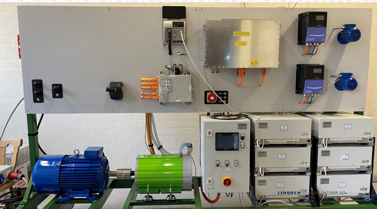
Testopstelling van de verschillende modules bij de ontwikkeling van de Linssen elektrische aandrijving.
